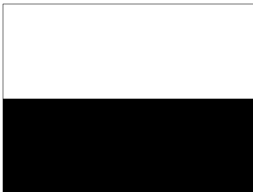
Fig.2-22 白(輝度値 255)黒(輝度値 0)の2色によるエッジをもつテクスチャ
