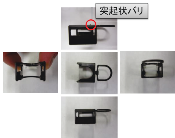
Fig.4-7 樹脂部品の突起状バリ
