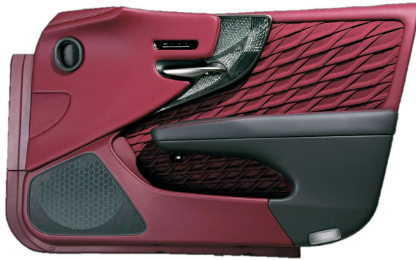
図3 LSラグジュアリー仕様のドアトリム 11
