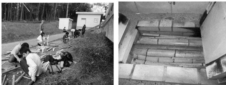
写真 3.2 竹材料の調製と窯詰め作業の様子 (左：豊田キャンパス内での竹材の調整、 右：窯に詰めた竹材)
